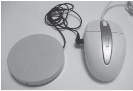
図 8 改造マウス完成
